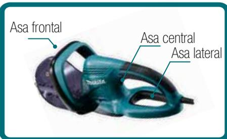
Cada una de las tres asas está equipado con un interruptor. Las cuchillas empiezan sólo cuando dos de los tres interruptores se enganchan al mismo tiempo, y se detienen inmediatamente cuando uno de los dos interruptores se suelta.
