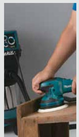
**1. Modo orbital** para acabados de lijado y pulido. El movimiento es hecho de forma orbital con una rotación de menor intensidad, la máquina se detiene si se ejerce mucha presión con la mano.
