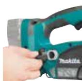
Entrada para rellenar el aceite. Con visor del estado del depósito.
