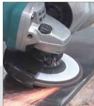
*Las fibras de vellón finas y flexibles ofrecen un buen acabado de la superficie.
