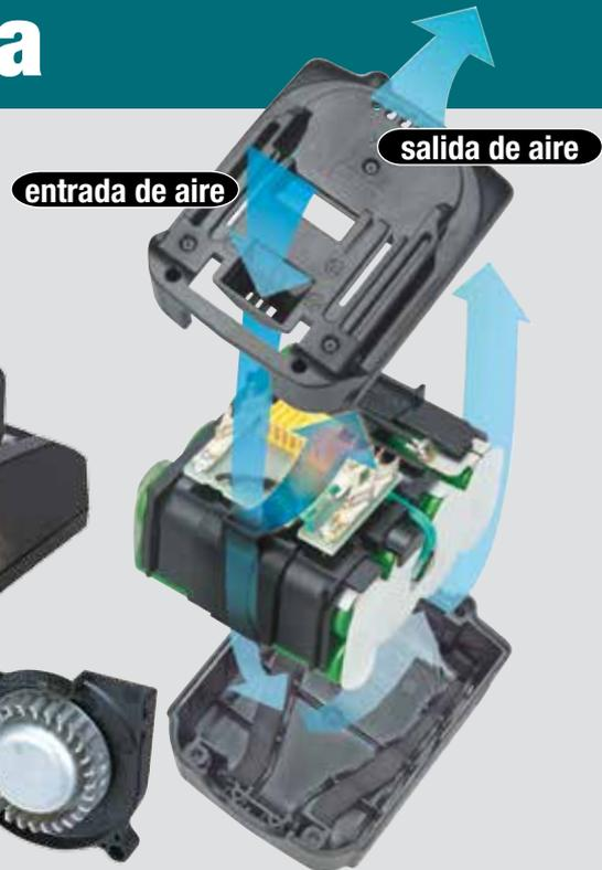
Después de usar una batería y debido al aumento de la temperatura, es siempre necesario enfriarla antes de cargarla. MAKITA ha desarrollado un sistema de carga con ventilador integrado en el cargador para una efectiva refrigeración de la batería antes y durante la carga evita el sobrecalentamiento, alargando así la vida de estas.
