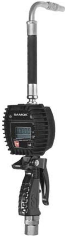
Pistolas contadoras volumétricas con registrador electrónico. Provistas de cámara volumétrica de engranajes ovals, registrador electrónico de lectura digital, tecla de calibración para un fácil ajuste del volumen real dispensado, empuñadura ergonómica antideslizante, con acoplamiento embreadado al cuerpo del registrador que asegura un perfecto alineamiento con el eje de la empuñadura, libre de fuga; gatillo de regulación de caudal y rótula giratoria en la conexión de entrada.
