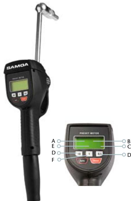
Pistola contadora volumétrica con registrador electrónico con función de preselección de la cantidad a suministrar. Provistas de cámara volumétrica de engranajes ovales, registrador electrónico de lectura digital, tecla de calibración para un fácil ajuste del volumen real dispensado, empuñadura ergonómica, gatillo de regulación de caudal y rótula giratoria en la conexión de entrada.
