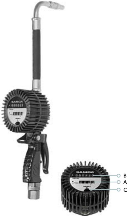
Pistolas contadoras volumétricas con registrador analógico. Provistas de cámara volumétrica de engranajes ovales, registrador de lectura analógico, con resolución en décimas de litro, empuñadura ergonómica antideslizante, gatillo de regulación de caudal y rótula giratoria en la conexión de entrada.
