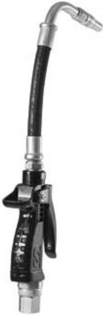
Pistolas para control de aceite medio caudal construidas en aluminio. Provistas de mecanismo de accionamiento progresivo de doble válvula mediante el gatillo de regulación que permite un óptimo control del caudal de entrega mínimo/máximo. Empuñadura ergonómica antideslizante con rótula de entrada. Presión máxima: 105 bar. Rosca de conexión: 1/2" BSP (H).
