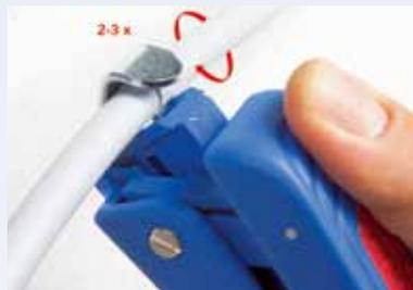
los cables múltiples. El diseño ergonómico permite pelar cables redondos de diámetro 4 – 28 mm.
