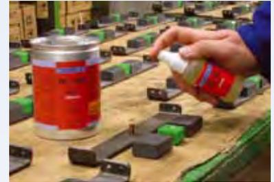
días antes de la unión final. La polimerización empieza cuando entran en contacto las dos superficies, una con activador y otra con adhesivo. El tiempo de polimerización es de 2 a 4 minutos.
