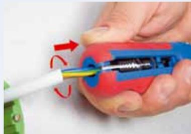
Para cortar cables fácilmente de diámetro entre 8 – 13 de diámetro, conductores de 0.5 – 6.0 mm<sup>2</sup> y cables coaxiales de sección 4.8 – 7.5mm.
