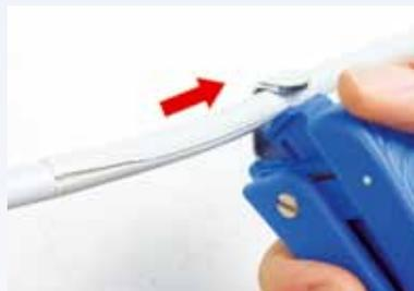
El sistema se ajusta automáticamente al diámetro del cable y permite pelarlo de forma rápida y precisa en un rango de 0,5 – 4,0 mm<sup>2</sup>.
