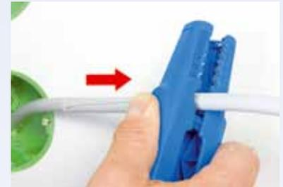
Permite el pelado circular y longitudinal del cable. Para
