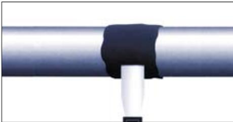
Rellene el área en reparación con el epóxico.
