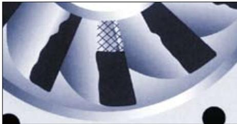
Recubra la malla de metal con epóxico y alise el acabado.
