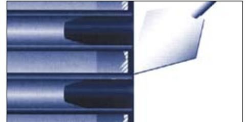
Reconstruya la superficie dañada con el compuesto Wear Resistant Putty.
