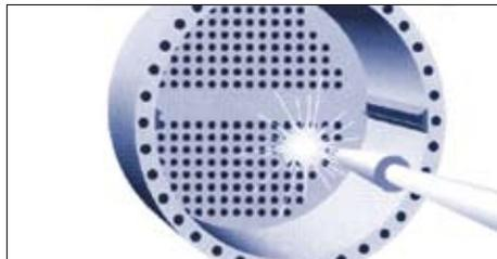
Arene la plancha de tubos después de instalar los tapones.
