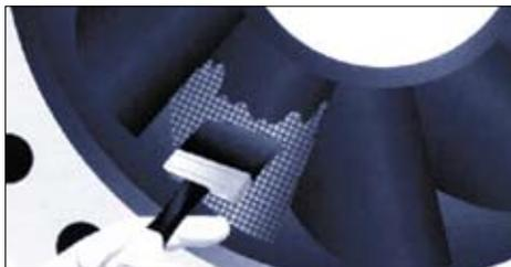
Dos capas de Brushable Ceramic sellan el metal y ofrecen una superficie de baja fricción.
