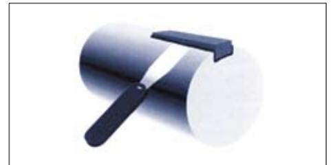
Retire inmediatamente el exceso de epóxico del área en reparación.
