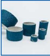
Anillos de tela resinada en zirconio reforzado internamente con un tejido especial. Se utilizan con esmeriladoras con velocidad regulable, no deben superar a 30m/s. Adecuados: pulido de troqueles, herramientas, empalmes, soldadura.
