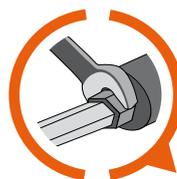
Perfil hexagonal con tuerca hexagonal permite el uso de una llave fija para los trabajos que requieren de un par extremadamente alto.
