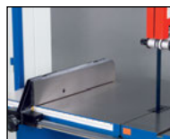
- Tope limitador paralelo estable, fabricado en fundición gris.
