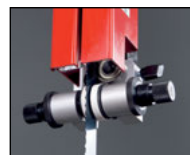
- Guía de cinta de sierra de 3 rodillos de precisión, con rodillos de guía de cerámica.
