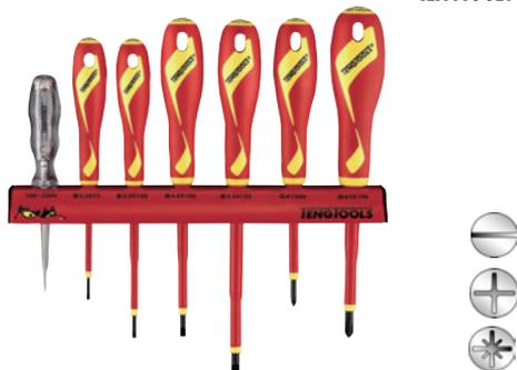
Juego de 6 destornilladores aislados planos, Philips, Pozidriv y un probador para tensiones entre 100 a 250 V. Cada destornillador ha sido probado y aprobado para trabajar a 1000 voltios según IEC 60900 standard individualmente. Suministrado con soporte de pared.
