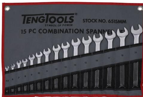
Cromo vanadio. Mismas dimensiones en los dos extremos. La boca bihexagonal tiene un ángulo de inclinado de 15°. Bocas pulidas. Acabado mate. En bolsa enrollable.
