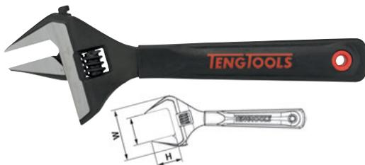
Con gran abertura. Cromo vanadio. 15° ángulo de boca. Para el trabajo que exige una gran abertura con un par bajo. Con mango ergonómico con dos componentes. Fabricado según la norma ISO 6787-1982, ISO 6787-1982, ASME B. 107.8-1996, BS 6333-1995, DIN 3117-1988, JIS B4604-1976. Acabado fosfato.
