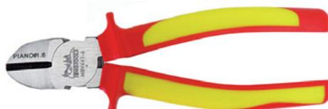
Corte lateral aislados Mega Bite. Cromo molibdeno. Ángulo de corte de 80°. Fabricados y certificados de acuerdo a la norma EN 60900. Aptos para trabajos en tensión hasta 1000 voltios AC.
