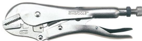
Plateadas, serrada, boca recta. Autobloqueo y palanca de extracción. Cromo vanadio.
