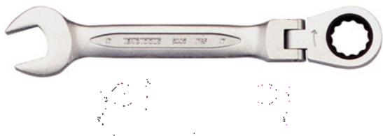
Combinación de estrella plana/llave fija con carraca bihexagonal con articulación flexible a 180°. Mismas dimensiones en los dos extremos, ángulo de inclinación de 13°. Cromo vanadio. Acabado mate.
