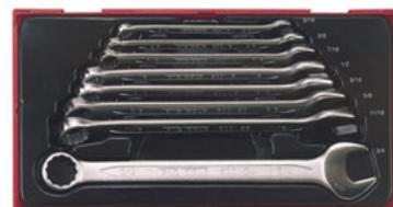
Juego de 12 llaves combinadas, pulgadas. Acero cromo vanadio. Mismas dimensiones en los dos extremos. La boca bihexagonal tiene un ángulo de inclinación de 15°. Bocas pulidas. Acabado mate.
