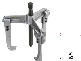
Acero forjado. Los brazos se pueden deslizar sobre el yugo para uso interno o externo. Las garras son largas y tienen un campo de aplicación amplio, que elimina el daño a la pieza de trabajo. Garra extra y husillo disponible sobre pedido.
