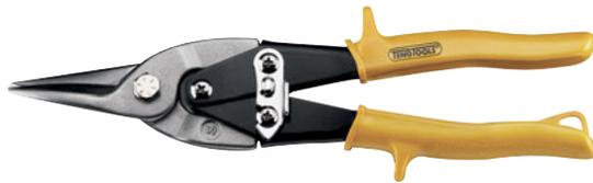
Filos dentados de acero molibdeno, endurecido por inducción a HRC 60-62. Para un máximo de 1,5 mm en chapa de acero laminado en frío. Mangos con fundas de plástico. Palanca de bloqueo de la hoja. Longitud 250 mm.
