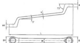
LLAVES DE ESTRELLA ACODADAS DE DOS BOCAS. Con diferentes tamaños de bocas bihexagonales en cada extremo. Ángulo doble curvo de 75°. Métricas, DIN 838. Cromo vanadio. Acabado mate.
