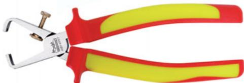
Pelacables. Cromo molibdeno. Ángulo de corte de 80°. Fabricados y certificados de acuerdo a la norma EN 60900. Aptos para trabajos en tensión hasta 1000 voltios AC.
