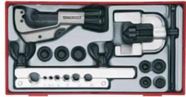
Extenso juego de herramientas para ensanchar tubos. Apropriado para cobre, latón y tuberías de aluminio de pared delgada. Cortes superiores a 32 mm de diámetro. La prensa de tubo de 45° ensancha tubos con diámetro de 4-14 mm.
