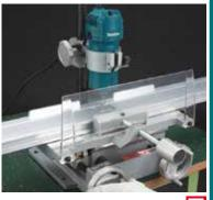
Potencia: 530 W R.P.M.: 30.000 Capacidad máxima: 6 mm Ancho máximo trabajo: 123 mm Altura máxima trabajo: 185 mm Desplazamiento máximo base: lateral 113 mm frontal 73 mm 15,9 Kg 2,5 M Peso:
