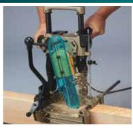
Potencia: 1.140 W R.P.M.: 3.200 130 mm Ancho de corte: Profundidad de corte: 155 mm 17,3 Kg Longitud del cable:
