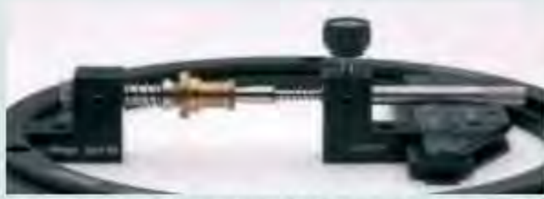
Sujección de una pieza cilíndrica entre puntas de amarre.
