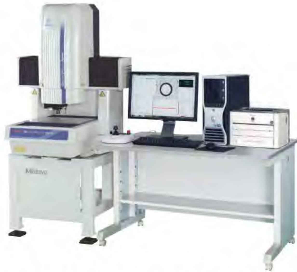
Quick Vision-APEX con opción de probeta de contacto
