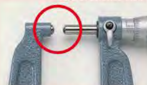
Tipo C : Esférico-esférico
