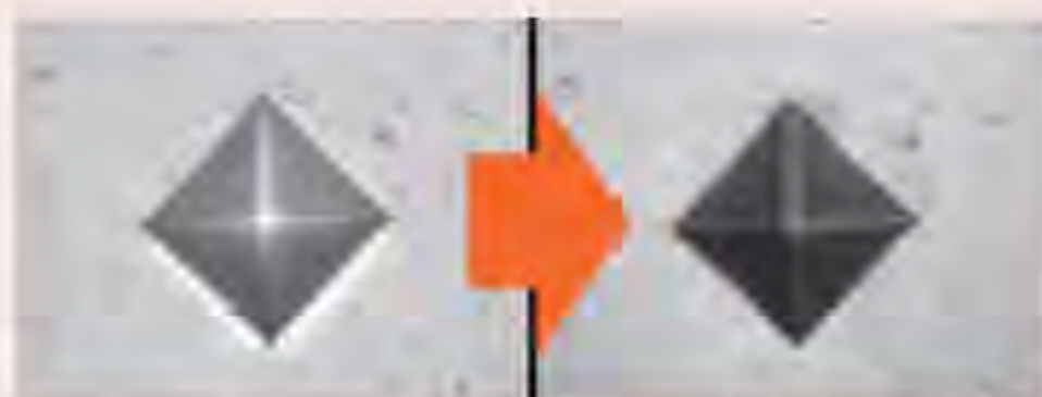
Observación de imagen de la huella (50X) Reducción de luz alrededor de la huella
