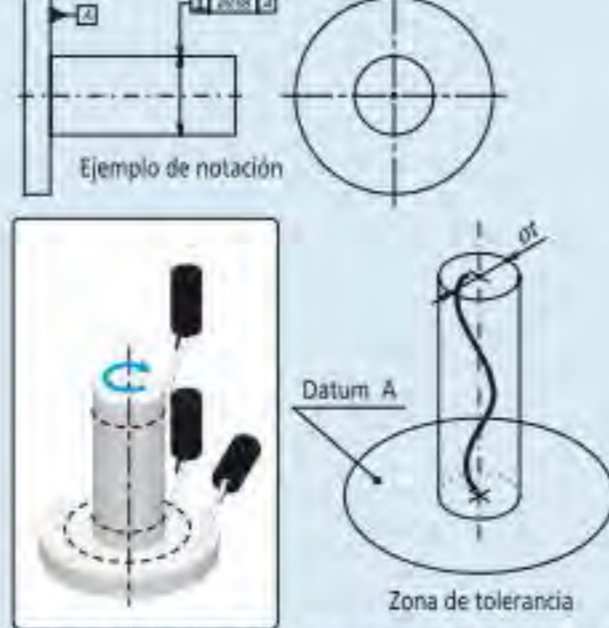
Ejemplo de verificación utilizando un aparato de medición de forma
