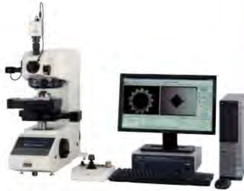
HM-210D/HM-220D modelos alta gama con auto-foco
