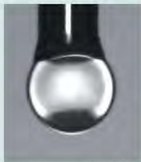
UMAP 130 ø300 µm L = 16 mm
