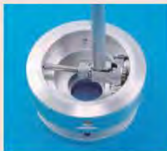
Extensiones para la medición de agujeros profundos (accesorio opcional)
