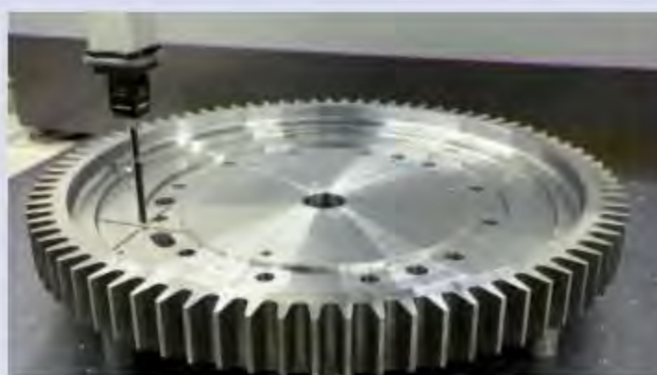
Medición en continuo con sonda SP80 y palpador 100 mm
