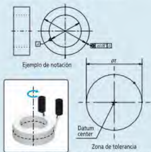
Ejemplo de verificación utilizando un aparato de medición de forma
