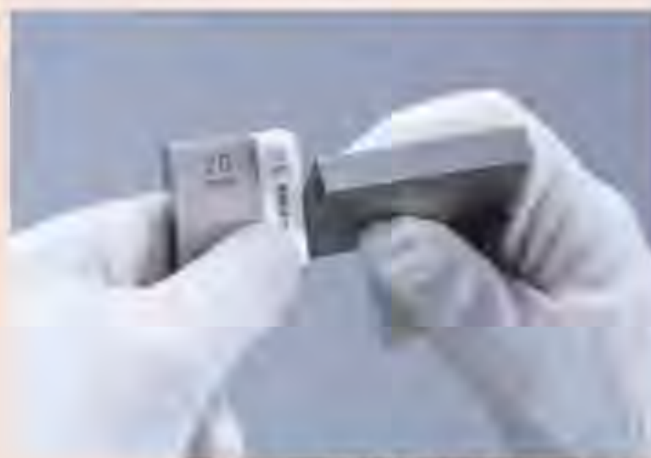
Bloques CERAMICA - No magneticos
