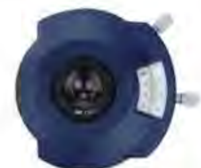
Ocular rotatorio con medidor de ángulos
