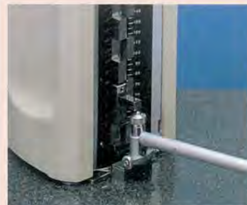
Ajuste de verificador de interiores
