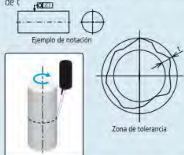
Ejemplo de verificación utilizando un aparato de medición de forma
