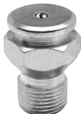
Engrasadores (DIN 3404-M22) con válvula de retención anticontaminación. Para orificios de lubricación con alto consumo, uso intenso y condiciones extremas, como maquinaria pesada de construcción, minería o ferroviaria, etc. Con cabeza de 22 mm Ø para un mayor paso de grasa. Utilización con grasa a presión mediante una boquilla de tipo Plana. Máxima presión de trabajo 950 bar.
