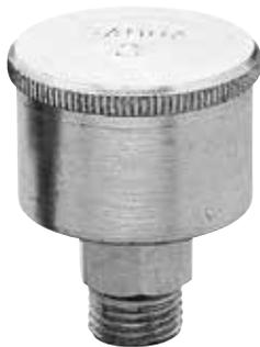
Lubricador (DIN 3411) para aplicación de grasa consistente, especialmente indicado en maquina herramienta. De fácil accionamiento, con cada giro de la tapa superior se entrega una fina cantidad de grasa a una presión de 50 bar. Sólida construcción de acero, resistente a impactos y altas temperaturas.
