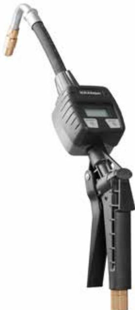
Pistola contadora electrónica construida en termoplástico anticorrosión de muy alta resistencia. Provista de medidor con cámara volumétrica de engranajes ovales en PVC y contador electrónico de lectura digital multifunción para un fácil control del volumen real dispensado en cada operación. Empuñadura ergonómica realizada en termoplástico de alta resistencia, con gatillo de regulación de caudal y rótula giratoria en la conexión de entrada.
