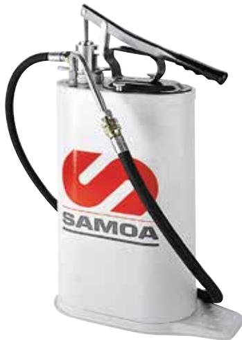
Para suministro de lubricantes viscosos (aceite de engranajes). Accionamiento mediante bomba de palanca de media presión que entrega 100 cc por ciclo. Depósito en acero de 16 l de perfil ovalado con robusta base para colocar el pie, boca de llenado de gran dimensión y asa de transporte. Incorpora flexible de caucho de 1,5 m con válvula y extensión giratoria en codo a 135° (314 540).
