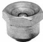
Engrasadores (LUB/DIN 3405-D1A) de bajo perfil con válvula de retención anticontaminación. Para insertar a presión en orificio de lubricación. Máxima presión de trabajo 150 bar.
