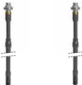
Tubos telescópicos para aspiración directa en depósitos con bombas de transvase. Incorporan conexión a bomba 1" BSP (M), adaptador de conexión a depósito 2" BSP (M), así como filtro con válvula de fondo 689 042.
