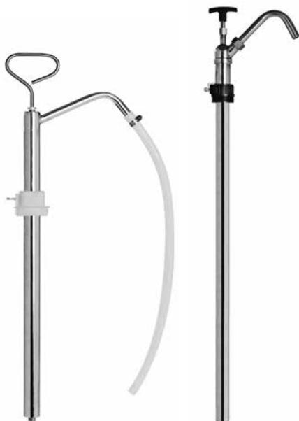
Bombas manuales de accionamiento vertical para transvasar productos químicos agresivos, disolventes, desengrasantes, etc. desde bidones de 25 o 205 l según modelo. Bombas realizadas en acero inoxidable AISI 316 y juntas de estanqueidad en Teflon®. Conexión a bidón 2" BSP (M).
