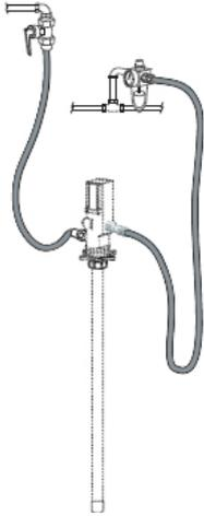
Los kits de conexión incluyen los elementos necesarios para la conexión de bombas a la línea de alimentación neumática y de la salida de fluido de la bomba con la línea de impulsión de fluido.
