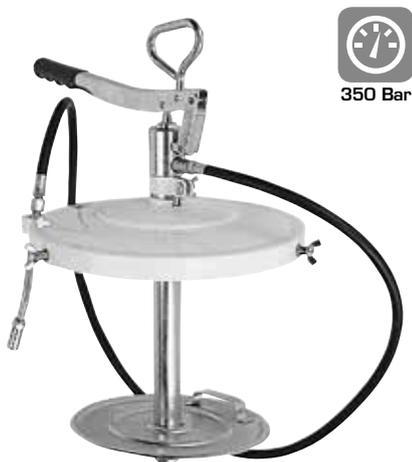
Bombas de engrase construidas en acero para acoplamiento directo sobre bidones originales de grasa. Presión máxima: 350 bar. Entrega por ciclo: 2 cc. La bomba, dotada de empuñadura de transporte, está provista de tapa con adaptador, disco seguidor y flexible de 1,5 m terminando en acoplamiento rígido con boquilla cuatro grapas con válvula (715 520).
