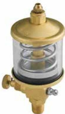
Engrasador automático con depósito transparente incorporado, provisto de émbolo de empuje accionado por resorte para la dosificación de grasa. Carga mediante bomba de grasa con boquilla hidráulica mediante la cabeza del engrasador hidráulico situada bajo el depósito. Dimensiones: 50 mm Ø x 125 mm de altura.
