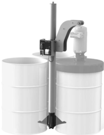
Permite elevar rápidamente cualquier bomba neumática PM45 & PM60 desde un bidón de grasa (185 kg) o de aceite (200 l o 60 l) y bajarla para ser acoplada en otro. Permite un cambio rápido del bidón y puede utilizarse tanto con un bidón como girando el conjunto para dar servicio a 3 bidones desde una misma ubicación.
