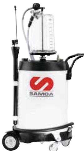
Unidades móviles para la recuperación de aceites usados por aspiración a través de la guía de varilla de nivel de aceite del motor. La aspiración se produce debido a la depresión creada por una bomba neumática de vacío, pudiendo efectuarse con la unidad desconectada de la red de aire, una vez alcanzada la depresión adecuada en el depósito indicada por el vacuómetro incorporado.
