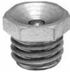
Engrasadores (LUB/DIN 3405-D1) de bajo perfil con válvula de retención anticontaminación. Para orificios de lubricación. Utilizados para lubricación con grasa a presión mediante una boquilla de tipo Punta o aceite lubricante inyectado con una aceitera manual. Realizados en acero zincado. Máxima presión de trabajo 400 bar.
