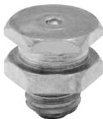
Engrasadores (DIN 3404-T1B) con válvula de retención anticontaminación. Para orificios de lubricación con uso intensivo, en maquinaria de construcción, minería o ferroviaria. Utilización con grasa a presión mediante una boquilla de tipo Plana. Máxima presión de trabajo 400 bar.
