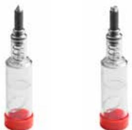
Bombas de engrase de accionamiento por empuje. El accionamiento se realiza presionando la bomba de forma alternativa contra el engrasador. Realizadas en plástico transparente. Uso con grasas blandas o aceite. Carga a granel. Presión de entrega hasta: 150 bar.
