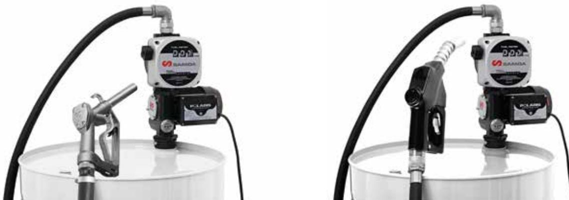
Kits de suministro instalables con bombas de corriente alterna 230 V Serie Polaris, contador, accesorios de conexión y de servicio según configuración. Versiones con bomba de 50 o 70 l/min, boquerel standard o automático, contador volumétrico analógico (999 l) y mangueras de servicio.
