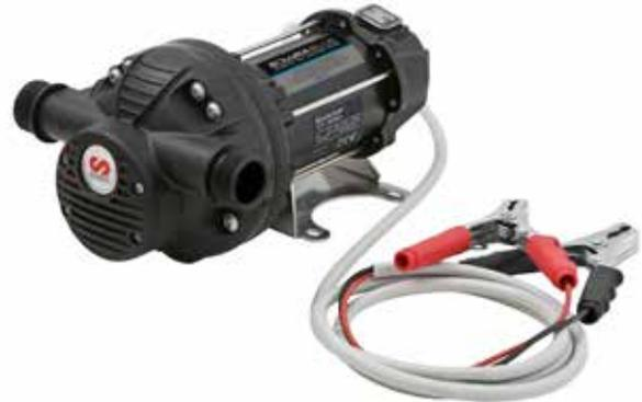
Electrobombas para transvase de fluidos agresivos como las soluciones de urea en agua (AdBlue®), dotadas de motores de corriente alterna 230 V o de corriente continua 12 V/24 V. Bombas multidiafragma sin juntas de eje y autoaspirantes.
