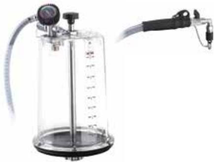
Pre-cámara visualizadora transparente de alta resistencia de 10 l de capacidad y sistema de vaciado rápido "Twist Lock" que permite, a su vez, la comunicación con el depósito. Dotado de bomba neumática de vacío de alto rendimiento y bajo nivel sonoro con vacuómetro, manguera de aspiración de 2 m con empuñadura de caucho y conector universal tipo **Mercedes Benz** con tapón antigoteo. Conexión a depósitos de aspiradores mediante unión roscada 1 1/2" BSP (H).
