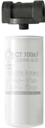
Filtros para gasóleo que permiten la eliminación de impurezas hasta 30 micras y del agua contenida en el combustible, gracias al material hidrófilo del elemento filtrante, evitando el suministro de gasóleo contaminado. Unidades suministradas con cabezal porta filtro con conexión roscada. También sólo filtros para recambio.
