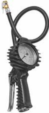
Pistola verificador de inflado homologada de acuerdo a la directiva 86/217 CEE que incorpora una carcasa de caucho protector con un colgador en la parte superior y un flexible de 500 mm con boquilla autosujetable. Llenado y vaciado mediante gatillo. Conexión con rosca de entrada 1/4" BSP (H).
