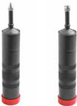
Bombas de engrase de accionamiento por empuje. El accionamiento se realiza presionando la bomba de forma alternativa contra el engrasador. Construcción metálica. Uso con grasas blandas o aceite. Carga a granel. Presión de entrega hasta: 150 bar.
