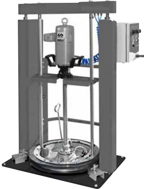
Equipos para suministro de grasa configurados mediante una bomba neumática de alto rendimiento montada sobre un elevador-inductor neumático de dos columnas consistente en un plato inductor de doble labio para bidón de 185 kg que va unido mediante barras a una estructura ajustable en altura formada por dos cilindros neumáticos, una viga puente y una robusta placa de base.
