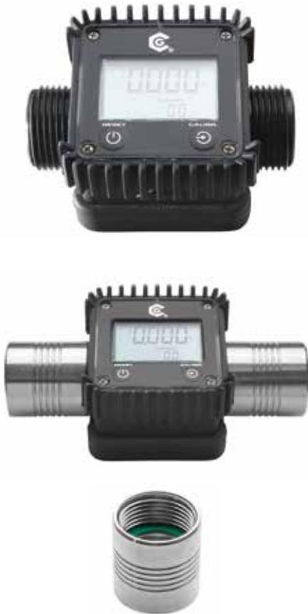
Contadores para ser intercalados en la línea de distribución de fluido permitiendo el control de los volúmenes transvasados. Provisos de cámara medición con sistema de turbina, registrador electrónico con display de cristal líquido, lectura digital con indicador parcial de la cantidad suministrada, tecla de puesta a cero, totalizador inalterable y función de calibración para un fácil ajuste del volumen real dispensado.
