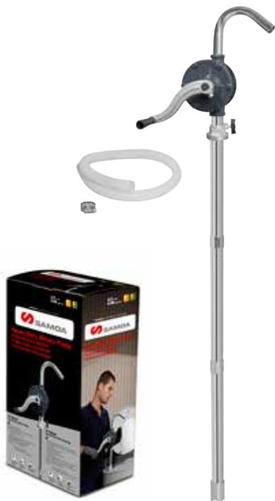
Bomba autoaspirante manual de accionamiento rotatorio para transvase de gasóleo, petróleo, aceite y otros fluidos no corrosivos de baja viscosidad. Incorpora: cuerpo de bomba realizado en aluminio, rotor y eje en zamak, adaptador 2" BSP (M) ajustable en altura para fijación al bidón, tubo para aspiración realizado en tres piezas de acero zincado con válvula de pie, juntas tapa-cuerpo en NBR y flexible de salida de 1 m. Entrega 0,3 l por revolución.
