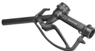
Boquereles para suministro de combustible a vehículos. Versiones realizadas en aluminio o termoplástico, con operación de corte automático o mediante gatillo (estándar). Todas las versiones incluyen rotula giratoria en la conexión de entrada.
