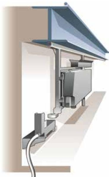
Unidades con depósito de 60 l diseñadas para ser instaladas suspendidas del voladizo de un foso desplazándose sobre la pared. El depósito articulado sobre chasis de la unidad incorpora un embudo con tapas, ajustable en altura, y un indicador de nivel. Cuando la unidad está llena, se desliza el conjunto del carro hasta un extremo del foso procediéndose a la descarga instantánea a una cisterna enterrada o a un depósito intermedio de evacuación.
