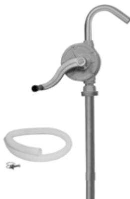
Bomba autoaspirante manual de accionamiento rotatorio para transvase de gasóleo, petróleo, aceite y otros fluidos no corrosivos de baja viscosidad. Incorpora: cuerpo de bomba realizado en hierro fundido y eje en acero, adaptador 2" BSP (M) ajustable en altura para fijación a bidón y tubo de succión realizado en 3 piezas (para utilización en bidones de 25, 50 o 205 l) y flexible de salida de 1 m. Entrega 0,3 l por revolución.
