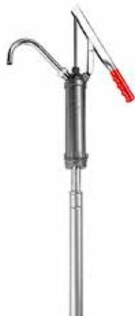
Bomba de accionamiento a palanca para transvasar refrigerantes de motor, alcoholes, desengrasantes, disolventes y aceites desde bidones de 60 o 205 l. Cuerpo de bomba y tubo de aspiración telescópico de acero, cabezal de aluminio, pistón de acero con segmentos de bronce y juntas de Viton®. Conexión a bidón 2" BSP (M). Entrega 0,45 l por ciclo (16 l/min).
