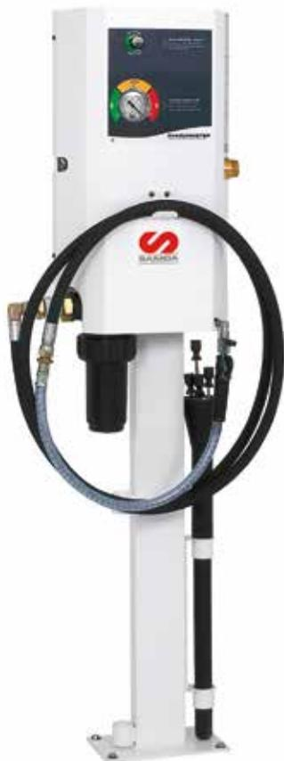
Unidad para recuperación del aceite usado de vehículos mediante aspiración con bomba de pistón, utilizando una sonda a través de la guía de nivel de aceite del motor. El sistema permite la aspiración del aceite usado y su impulsión simultánea a un depósito de almacenamiento remoto. Instalada en el área de trabajo, es un método limpio para la extracción del aceite usado de los vehículos.
