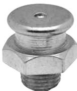
Engrasadores (DIN 3404-M1) con válvula de retención anticontaminación. Para orificios de lubricación con uso intensivo, en maquinaria de construcción, minería o ferroviaria. Utilización con grasa a presión mediante una boquilla de tipo Plana. Máxima presión de trabajo 400 bar.
