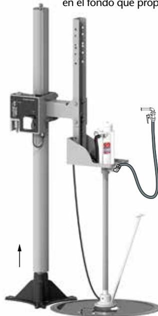
Equipos para suministro de grasa configurados mediante una bomba neumática de alta presión montada sobre un elevador neumático de una columna y con un plato inductor monolabio acoplado, de forma fija a la entrada de la bomba.
