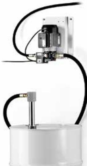
Kit mural de electrobomba con dispositivo automático de control AutoFlo 230 V 780 W. Presión de entrega fluido: 15 bar (565 100) y 24 bar (565 300). Conjunto aspiración desplazada para toma superior del contenedor o para bidón de 205 l. Especialmente indicada para sistemas monopunto de suministro de aceite provistos de enrollador de manguera y contador.
