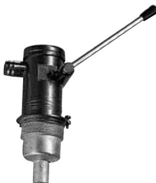
Bomba para transvase por sifonamiento, mediante palanca alternativa. El transvase por sifonamiento, una vez que la bomba ha sido cebada, proporciona un flujo continuo de 8 l/min. Válida para anticongelantes, disolventes, alcoholes, desengrasantes y otros fluidos industriales no corrosivos. Conexión a bidones 2" BSP (M) para bidones de 60/205 l. Incluye: flexible transparente de 1,5 m, boquedel metálico y tubo de aspiración en PVC.
