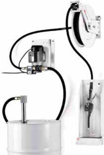
Conjunto mural de electrobomba con dispositivo automático de control AutoFlo 230 V 780 W. Presión de entrega fluido: 15 bar. Conjunto aspiración desplazada para toma superior del contenedor o para bidón de 205 l. Equipado con: enrollador de manguera mural, pistola contadora electrónica y soporte antigoteo para pistola. Indicado para utilización con todo tipo de aceites.
