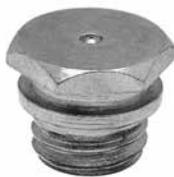
Engrasadores (DIN 3404-T1) de bajo perfil con válvula de retención anticontaminación. Para orificios de lubricación que demanden mínimo resalte sobre la superficie de la pieza a lubricar. Utilizados para lubricación con grasa a presión mediante una boquilla de tipo Plana. Máxima presión de trabajo 400 bar.
