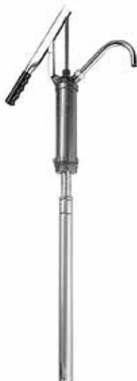
Bomba de accionamiento a palanca para transvasar todo tipo de lubricantes ligeros y otros fluidos no corrosivos desde bidones de 60 o 205 l. De aplicación en automoción, agricultura e industria para fluidos como aceites de motor, de engranajes, de transmisión, refrigerantes y aceites de corte, hidráulico, petróleo (keroseno).
