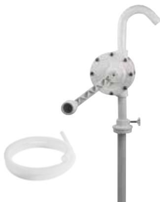
Bomba manual de accionamiento rotatorio para transvase de fluidos corrosivos de base ácida y soluciones acuosas. Incorpora cuerpo de bomba realizado en PVC y eje en acero inoxidable, adaptador 2" BSP (M) ajustable en altura para fijación a bidón y tubo para aspiración en PVC realizado en 3 piezas (para utilización con bidones de 25, 50 o 205 l) Entrega 0,25 l por revolución.
