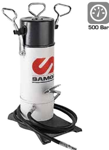
Bombas de engrase portátiles, de accionamiento a pedal. Depósito estanco, muy robusto y fácilmente transportable, 5 kg de capacidad y émbolo de alimentación de grasa accionado por resorte. Para utilización con grasas hasta NLGI-3.
