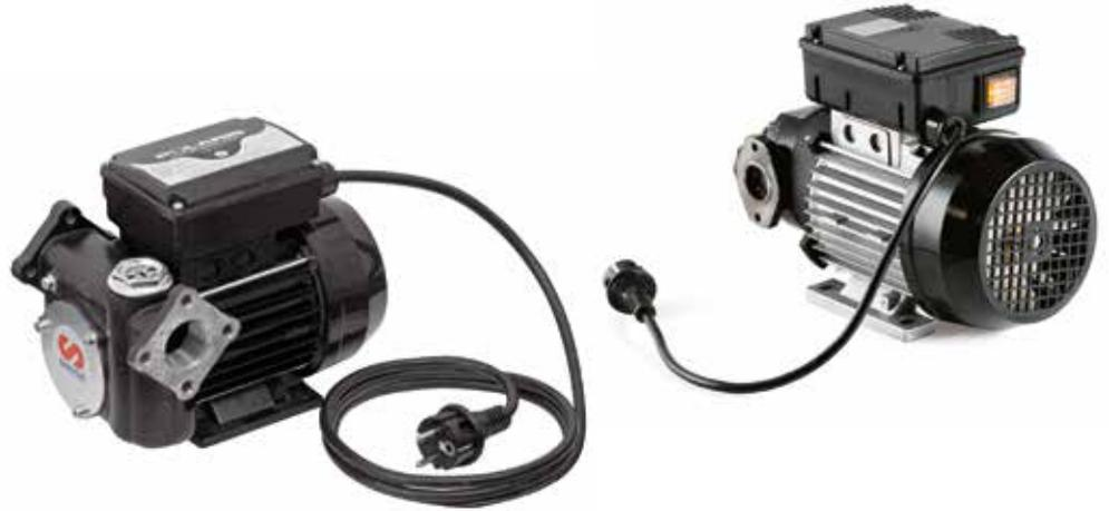
Electrobombas para transvase de gasóleo Serie Polaris, dotadas de motor de corriente alterna 230 V. Potencias de motorización, 370, 500 o 750 W, ofrecen un rango de caudales de entrega (50, 70 o 95 l/min), según la necesidad exigida.
