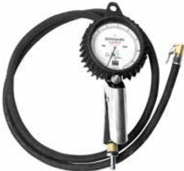
Pistola verificador de inflado, llenado mediante gatillo y vaciado desde botón purga. Manómetro de construcción integral sobre el propio cuerpo de la pistola, homologado y verificado oficialmente de acuerdo a la directiva 86/217 CEE. Flexible de 1.560 mm con boquilla autosujetable. Conexión para manguera de Ø 8 mm, con rosca de entrada 1/4" BSP (H).
