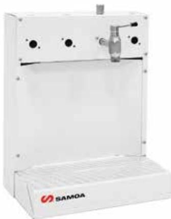
Consola bar dispensador para distribución de fluidos. Instalada como terminal de suministro de la línea de fluido. Alimentada por bombas neumáticas permite su dispensado a través de la válvula incorporada.
