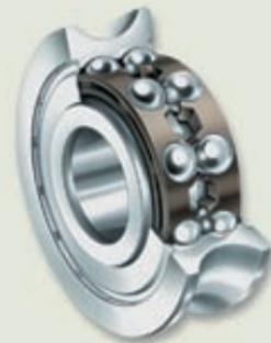
Rodillo-guía perfilado (rodillo fijo): rodamiento a bolas de contacto angular, de dos hileras, con anillo exterior perfilado en forma de arco gótico, obturado, engrasado y libre de mantenimiento.
