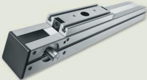
También son suministrables los módulos lineales miniatura: en perfiles rígidos de aluminio, con guía lineal con rodillos-guía incorporada en su interior, accionados por correa dentada y con un amplio programa de accesorios.
