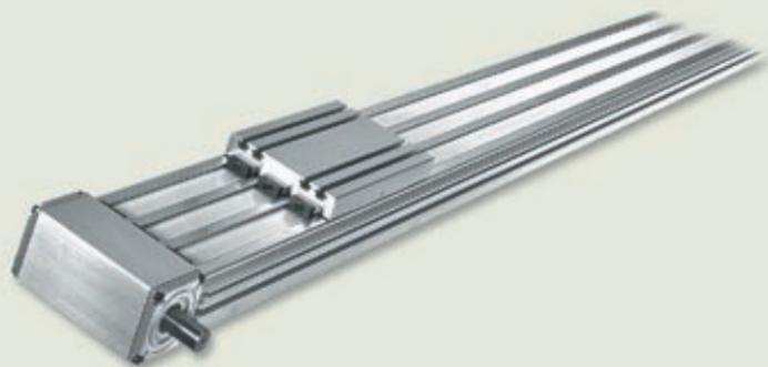
Están disponibles también los módulos para cargas pesadas: en perfiles de aluminio rígidos a la flexión, con sistemas con recirculación a bolas integrados en su interior, accionados por tres correas dentadas, apropiados para disposición vertical u horizontal y con una extensa variedad de accesorios.
