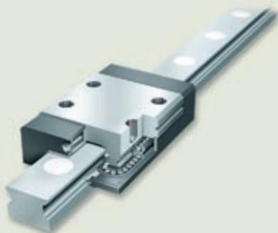
Precisión en un espacio constructivo reducido: sistema lineal miniatura con recirculación de cuatro hileras de bolas, en tamaños 12 y 15 (con recirculación de dos hileras, en tamaños 5 hasta 15).
