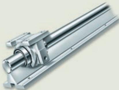
Excelente comportamiento de traslación: sistema de guiado por eje de alta rigidez, con rodamientos lineales a bolas de la serie maciza sobre carriles-soporte, con anillo exterior templado y rectificado con precisión.
