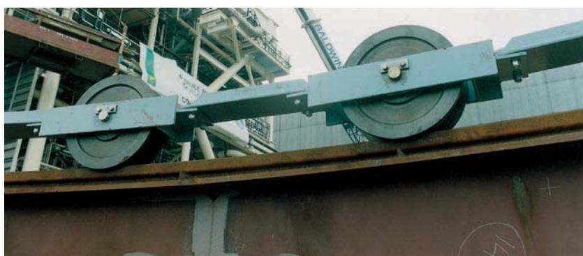
7.600 toneladas y 32 metros de diámetro, girando sobre ruedas de acero de doble pestaña sobre riel, con casquillos autolubricantes. Rueda \phi 450\text{ mm} . y ancho de banda 112 mm.
