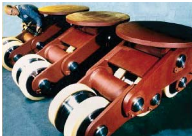
7.600 toneladas y 32 metros de diámetro, girando sobre ruedas de acero de doble pestaña sobre riel, con casquillos autolubricantes. Rueda \phi 450\text{ mm} . y ancho de banda 112 mm.
