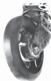
Banda de Vulkollan® Ha resistido perfectamente y conserva su perfil original.
