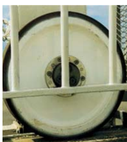
Ruedas de Vulkollan®(95° Shore A) \phi 500\text{mm} . y 100mm. de ancho de banda. Material colado sobre núcleo de aluminio anodizado (para reducir significativamente el peso, facilitar la manipulación y prevenir la corrosión).
