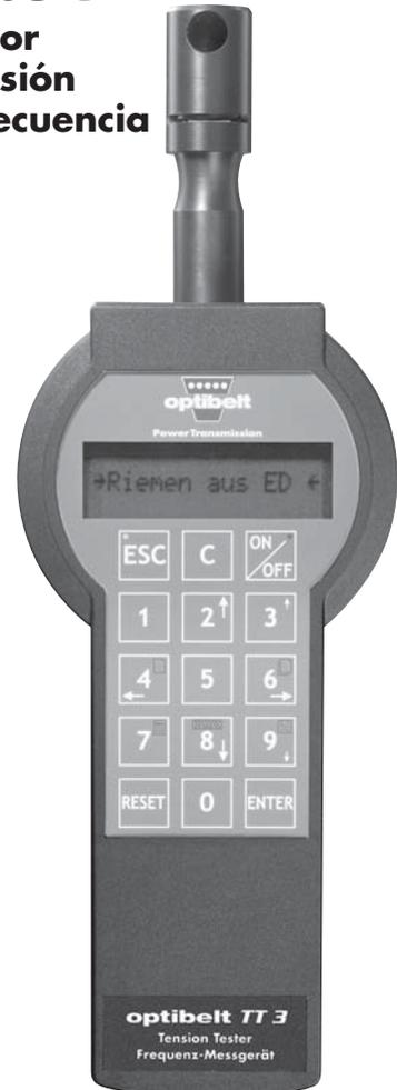
**El medidor de tensión optibelt TT3 sirve para comprobar la tensión de correas de transmisión gracias a medición de la frecuencia. La indicación se realiza directamente en hertzios [Hz]. La tensión se indicará en Newton [N]. cuando se introducen los datos de la transmisión.**
