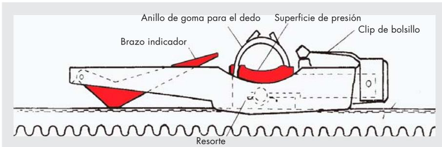
El medidor proporciona un método sencillo para las correas. Facilita al montador, p. ej., los trabajos de mantenimiento de las transmisiones por correas cuando no son conocidas las especificaciones técnicas y, por tanto, no puede calcularse la tensión óptima. Se tendrán que determinar el diámetro de la polea más pequeña, así como el perfil.
