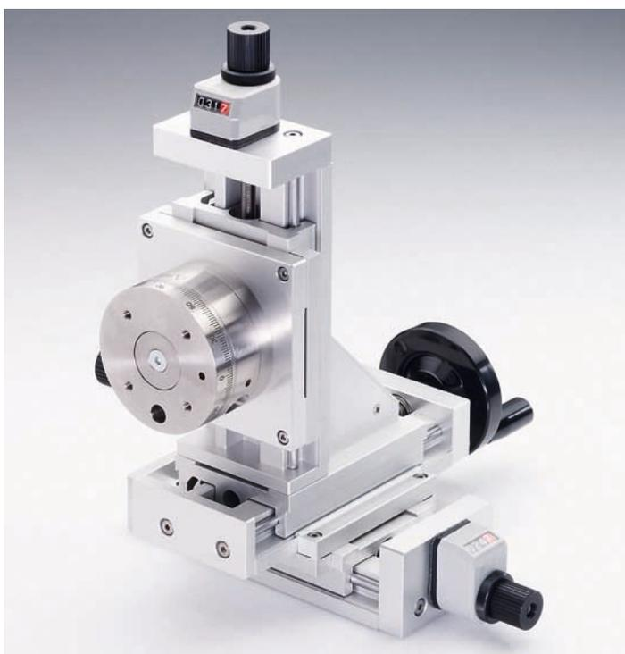
El conjunto graduable X-Y-Z consiste en tres MESAS DE COORDENADAS graduables GN 900, los ejes X - y Z con indicador de posición y además la MESA giratoria GN 900.6 montada sobre EL eje Z, ensamblado en UNA PLATAFORMA de montaje GN 900.4.
